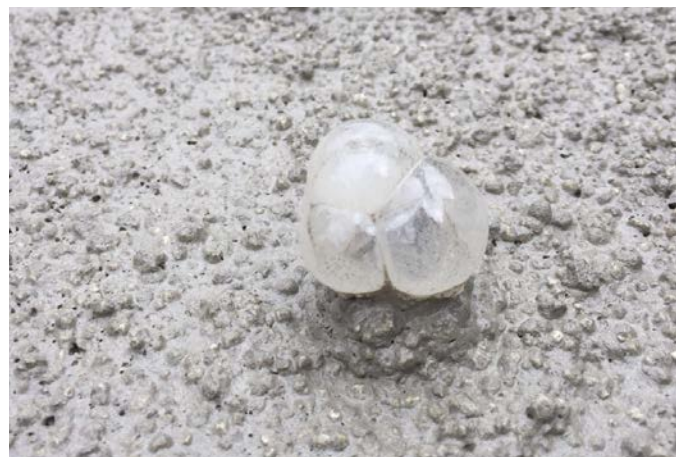
Die Luftporenbildung durch das einzigartige 4-Komponenten Bindemittel sorgt im Gesamtaufbau für die guten Dämmeigenschaften und ist schon kurze Zeit nach Einbau erkennbar.
